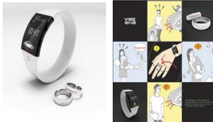
Figura 50 - Bracelet e anéis para surdos que consiste de dois anéis e um relógio de pulso que são projetados para atuar na percepção de sons vindos de trás (TUVIE, s.d.).
